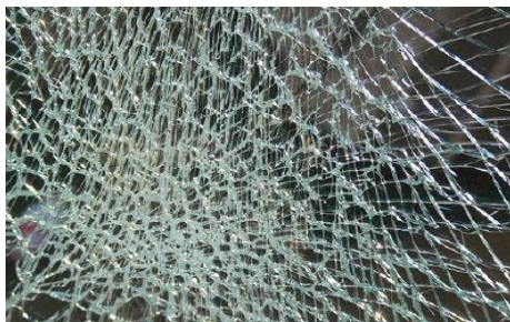
ลักษณะการแตกของกระจกแบบเท็มเปอร์
