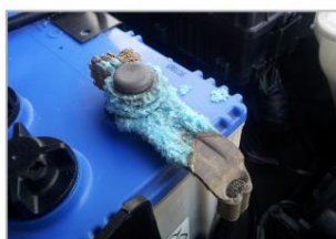
ขั้วแบตเตอรี่ขึ้นคราบเกลือ
