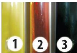
สีของน้ำมันเบรก 1-น้ำมันเบรกที่ปกติ 2-มีความชื้น หรือน้ำผสม 3-น้ำมันเสื่อมสภาพ ควรเปลี่ยน
