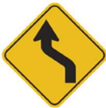
ป้ายเตือนทางโค้ง รัศมีแคบเลี้ยวซ้าย
